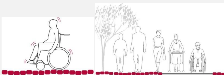
Fig. 42 y 43: El adoquín es un pavimento considerado inaccesible, debiendo diferenciarse la ruta accesible con una superficie más estable.
