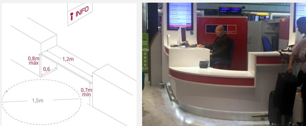
Fig. 60: Los mesones de atención deben considerar una altura, ancho y profundidad determinada.
