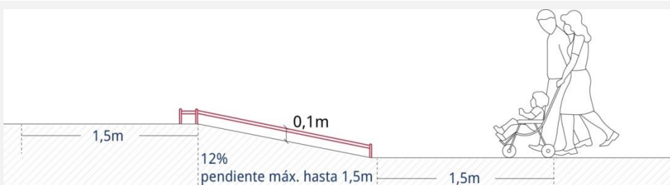
Fig. 52: Rampas de longitud inferior a 1,5m requieren de protección lateral de mín. 0,1m.
