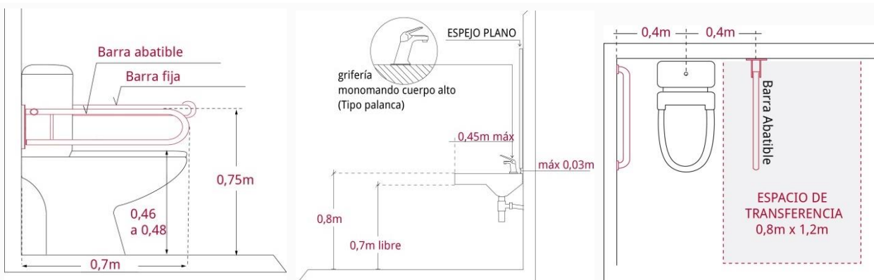
Fig 111 (izq): Requisitos para instalación de inodoro.
