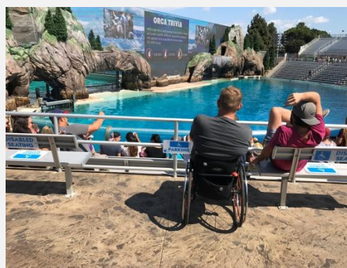
Fig. 90: No se puede interrumpir la línea de visión del espacio de permanencia por espectadores de pie ubicados adelante.
